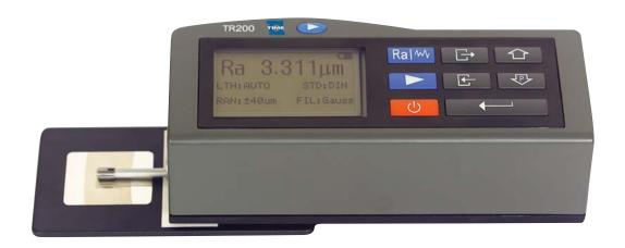
TR-200 SURFACE ROUGHNESS TESTER WITH 13 PARAMETERS
